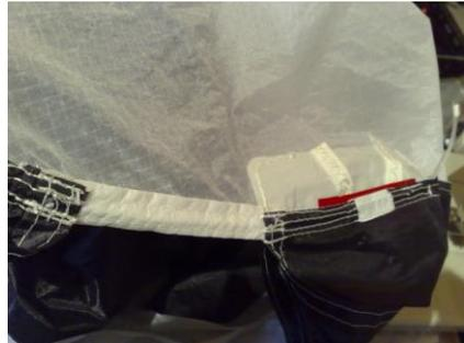
Dazu schiebt man das Stäbchen etwas zurück bis es aus der Tasche gleitet. Anschließend zieht man es heraus und überträgt die Länge exakt auf das Ersatzmaterial. Bevor der neue Stab eingesetzt werden kann, müssen seine Enden abgerundet und mit Gewebeband abgeklebt werden. Beim Einschieben muss man darauf achten, dass das Stäbchen wieder hinter die kleine Nähkante rutscht. Nur dann ist es in der Tasche arretiert.
